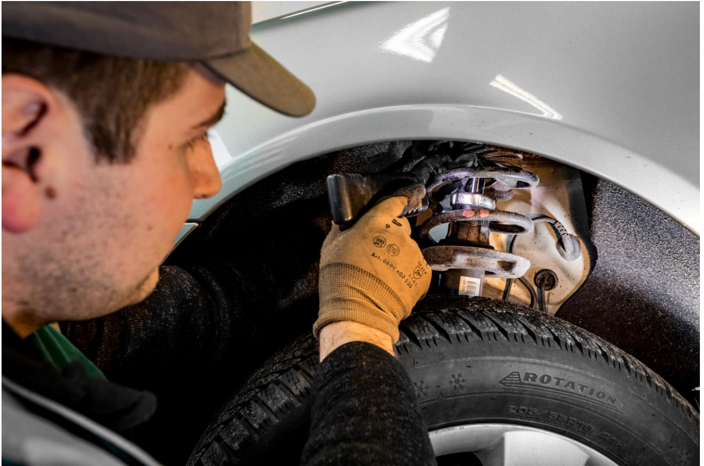
Un Contrôleur technique examine l'état d'un amortisseur.
