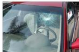
Plusieurs fissures sur le pare-brise, dans la zone de balayage des essuie-glaces.
