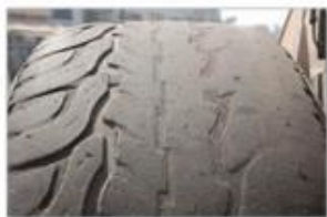
Corde visible sur un pneumatique ou profondeur d'au moins une rainure inférieure à 1,6 mm
